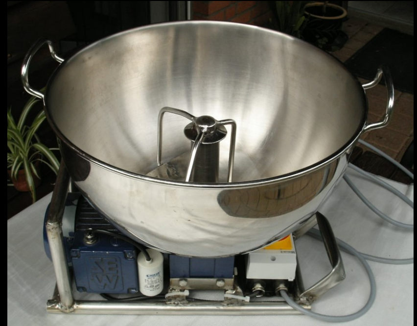
Eigenbau einer „Brot-Teig-Knetmaschine“ Geeignet für vier kg Mehl
